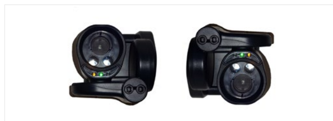
Abb. 40: Sender typisch montiert (links) und um 180^\circ gedreht
